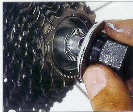
4 Appliquez une pointe de graisse sur le filetage de l'écrou. Après l'avoir vissé à la main, bloquez votre outil comme au démontage et serrez doucement. Le pas de vis est fin, vous risqueriez de l'abîmer. En cas de doute, utilisez une clé dynamométrique, le couple à appliquer est inscrit sur l'écrou.
