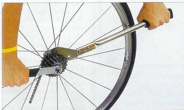
1 À l'aide d'un fouet à chaîne et de l'outil correspondant au type d'écrou (voir encadré Comparo), dévissez l'écrou de blocage. Pour ne pas riper, bloquez votre outil avec l'écrou du blocage rapide. Cela vous évitera d'endommager les cannelures auquel cas le tout serait indémontable !
