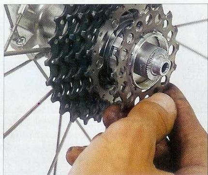
3 Avec le présentoir en plastique sur lequel est montée la nouvelle cassette, il est possible d'enfiler les pignons d'un seul tenant. Néanmoins, vous pouvez toujours y aller dent par dent ! Faites attention au sens car chaque pignon dispose d'un usinage spécifique.
