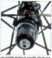
de positionner une rondelle derrière la cassette, afin de combler la différence d'épaisseur entre les cassettes dix vitesses Campagnolo et les neuf vitesses Shimano, ou autre...
