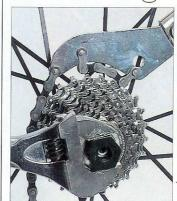
Le démontage s'effectue avec un fouet, ainsi qu'une clé permettant de desserrer la rondelle de la cassette. Les fouets "artisanaux" font très bien l'affaire, quelle que soit l'épaisseur des pignons, puisqu'il ne sert qu'à bloquer la roue libre. Il évite ainsi que lorsque l'on desserre l'écrou, elle tourne dans le vide...
